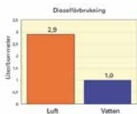
Diagram 3: Förbrukning av dieselolja (liter/borrmeter) vid luftborring (orange) jämfört med vattenborring (blå). Illustration: Peter F Johansson
