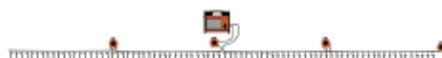
Fig 4. Ett standardutlägg för mätning av Resistivitet, IP och SP. Instrumentet i mitten, fyra mätkablar och 80 stålelektroder.
