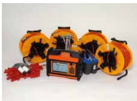
Fig 3. Mätutrustning för Resistivitet, IP och SP
