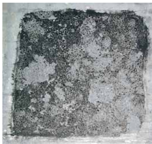
Figur 4 Provytan efter brandtestet på den tunga betongen utan polymerfibrer.
