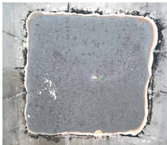
Figur 6 Provytan efter brandtestet på den tunga betongen med polymerfibrer.
