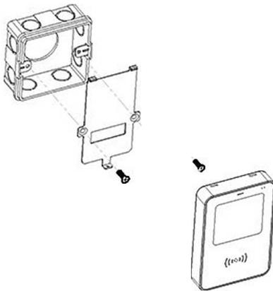
2. Halterung mit den m4\*20 Schrauben befestigen
