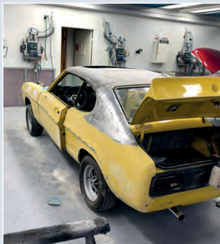
Vinyltaket fjernet og taket slipt ned til stålet før det blir grunnet.
