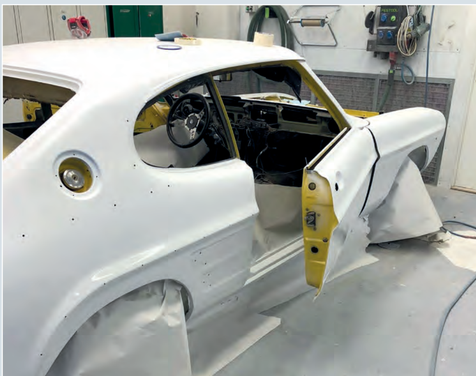
Etter mange timer der bl.a. en falsk takluge er fjernet er nå bilen grunnet utvendig.
