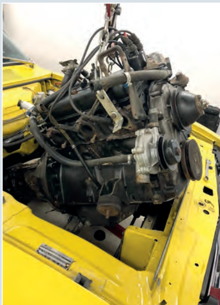
Motor demonteres og skal overhales.
