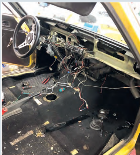
På ledningsnettets har det vært flere hobbyelektrikere, kanskje det ikke var så rart at det var mange svidde ledninger hvor isolasjonen var smeltet bort. Alt erstattet med et nærmest komplett nytt ledningsnett.
