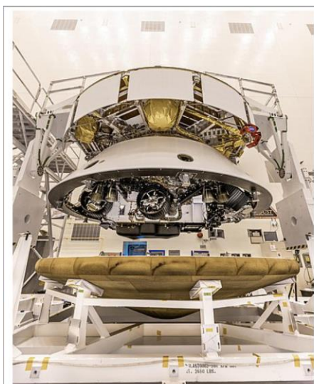
A gauche Mars 2020 en cours d'assemblage final. A droite Schéma 3 : Vue éclatée de la sonde spatiale. 1 - Étage de croisière, 2 - Bouclier arrière, 3 - Étage de descente, 4 - Astromobile, 5 - Bouclier thermique avant, 6 - Logement du parachute.
