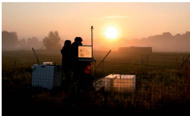
ABBILDUNG 21: Messung des CO 2 -Austauschs mit manuellen Hauben im Großen Moor bei Gifhorn
