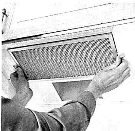
Filtret hålls på plats av två fjädrande plastknoppar. Håll emot filtret med handen. Skjut plastknopparna åt sidan och ta bort filtret.
