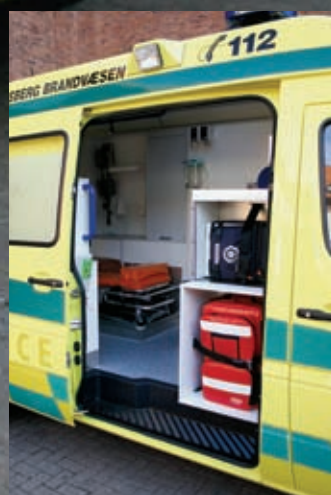
En lille detalje er, at defibrillatoren er placeret ved skydedøren, når den ikke er i brug, men skulle behovet opstå, kan den tages ud inde fra bærerummet uden at åbne skydedøre.
