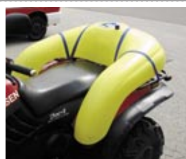
ATV'en er opbygget med en 80 liters vandtank med overtryk.
