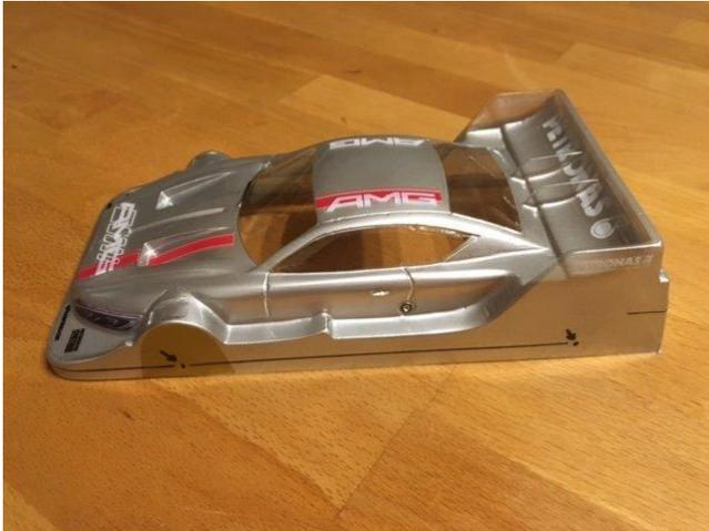
Auf der Karosserie befinden sich 2 Punkte, Verbinden Sie diese zwei, so erhält man ein Regelkonformer Schnitt. (Siehe Abbildungen)
