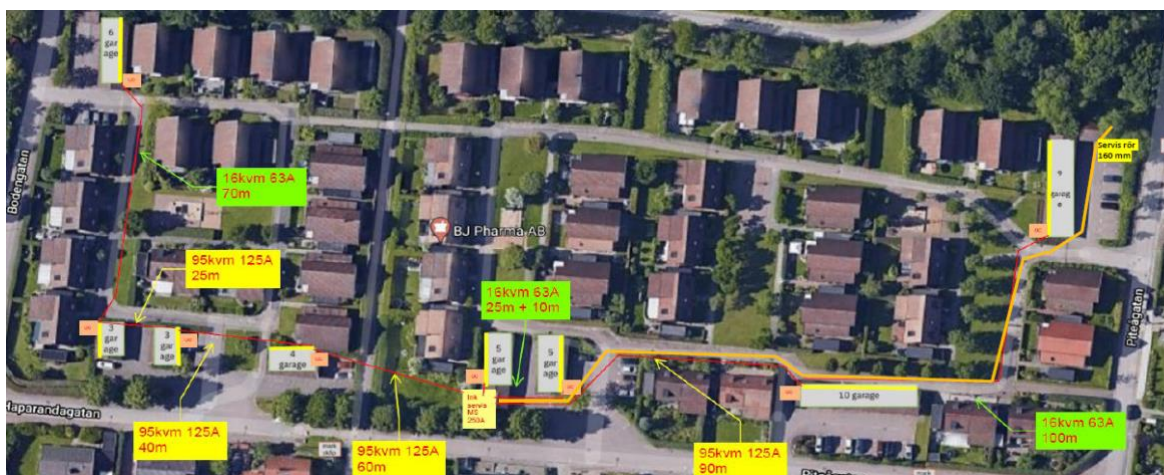
Ritning över entreprenad för en ny el infrastruktur (vi börjar från gård 1)
