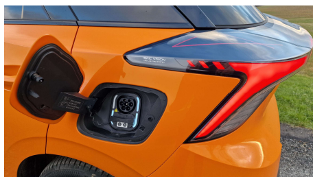
Opladning med CCS stik type 2, op til 135 kWh.
