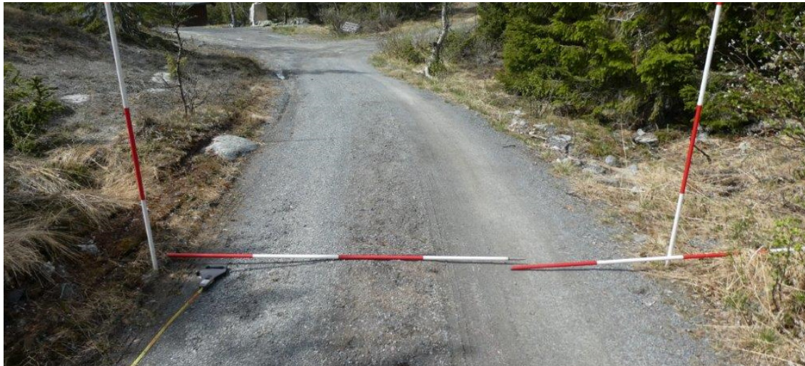
Vegbredde 2,9 meter veg 200 meter. Legg merke til stor stein i vegskulder på venstre side.
