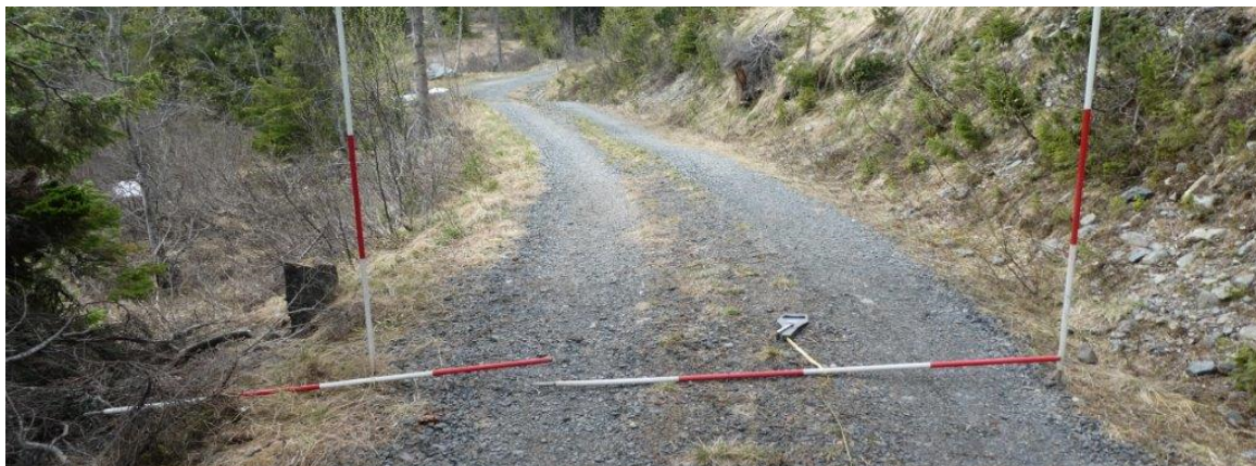
Vegbredde 2,75 meter ved 50 meter.
