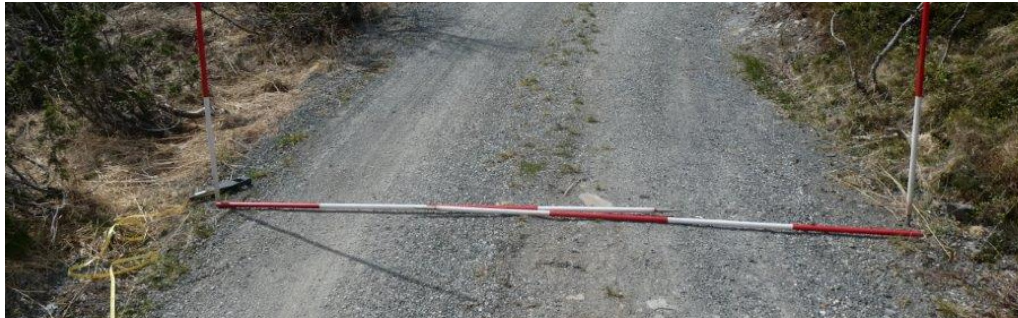
Vegbredde 3 meter ved 100 meter.
