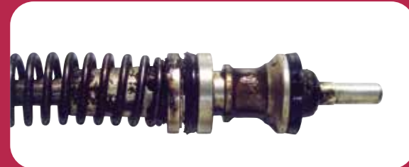
Skadelige aflejringer og ophobning som følge af udslidt og oxideret bremsevæske er synlige på denne hovedbremsecylinderstempel.
