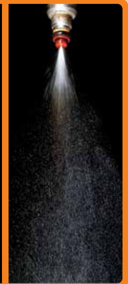
EFTER: En velfungerende brændstofdysse spreder brændstoffet som dis, således at brændstof/luftblandingen er korrekt afbalanceret og forbrændingen er optimal.
