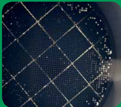
FØR: Diesel partikelfilter behandling. (DPF) skærm med stor akkumulering.
