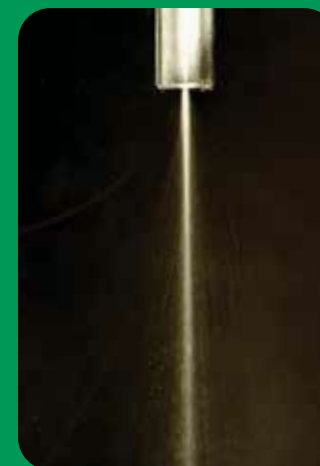
Forkert brændstofsprøjtemønster som følge af aflejringsophobning i dieselinjektor.
