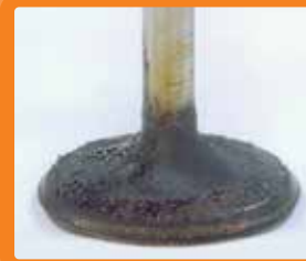
FØR: Indsugningsventil med ophobning af koksaflejring.
