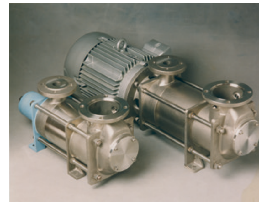
Før og etter monoblokk. Til venstre står ei pumpe med fleksibel kobling for bruk med ekstern elektromotor. På pumpa til høgre er motoren direkte kobla på akslingen i pumpa – altså ei monoblokk.
