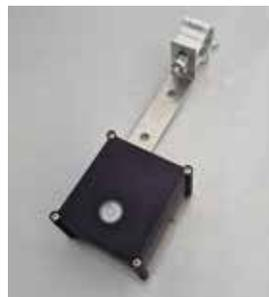
Die IBC-Montagehalterung kann einfach am Rahmen des IBC-Tanks angeschraubt werden, mit Hilfe einer Flügelmutter. Der Radar liegt dann horizontal auf dem IBC-Tank für die beste Messung. Bei
