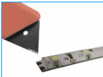
voděodolné pásky je nutno nejdříve odizolovat
