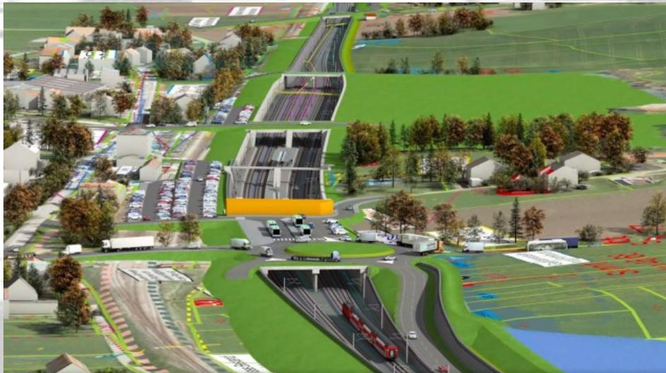
Diese Visualisierung der Vieregg-Variante hatten die Planer der Deutschen Bahn vorgenommen. Der Ausschnitt zeigt, wie die Gleise unter der B 15 hindurchführen und dahinter die tiefgelegten Bahnsteige (Bildquelle: *Visualisierung: DB Netz AG, veröffentlicht im Artikel der SZ*)
