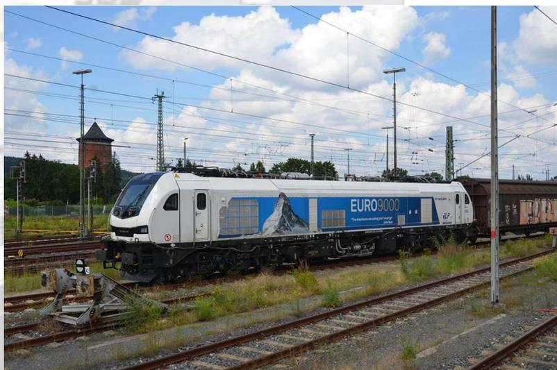
Die STADLER- EURO-DUAL firmiert hier beim European Loco Pool (ELP) als BR 159. Mit einem Güterzug zusammen stand sie abgestellt in Lichtenfels. Das 123 Tonnen schwere sechsachsige Kraftpaket bringt es auf eine Dauerleistung 7000 kW unter 25 kV, 6150 kW unter 15 kV und immer noch 2800 kW mit dem Dieselmotor. Damit ist je nach Anhängelast eine Höchstgeschwindigkeit von bis zu 160 km/h möglich (TFi)
