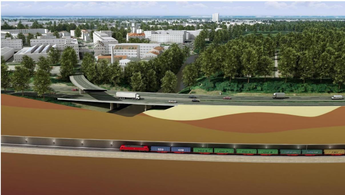
*In 40 Metern Tiefe sollen die Güterzüge künftig unter der Pegnitz und der Stadtgrenze von Nürnberg und Fürth durchrollen, bevor sie mehrere Kilometer lang zunächst unterirdisch und dann an der Oberfläche an der A73 entlangfahren. Hier, unter dem Fluss, befindet sich die tiefste Stelle. © DB AG*
