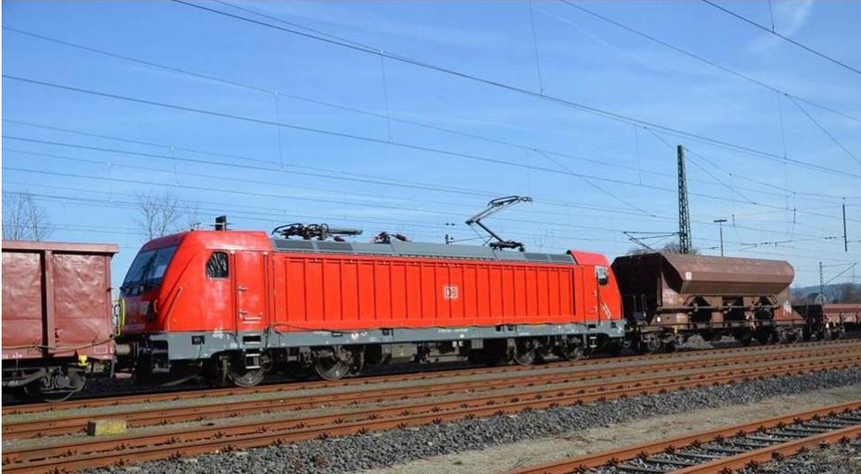
Wie unterschiedlich sich ein kleiner Ausrüstungsgegenstand, das Flex- Panel, auf das Aussehen einer Lok TRAXX 3 (Baureihen 147, 187 und 188) auswirken kann! Das Flex- Panel war DAS Verkaufsargument von Bombardier für flexible Platzierung von Werbung. Keine aufwendige Beklebung mehr, statt dessen wird auf beiden Seiten innerhalb einer Stunde eine Plane angebracht. Diese 187er von DB Cargo kam leider nicht in den Genuß der Panels und steht so da im schönsten Licht mit ihrem „Heizkörper- Design“.
