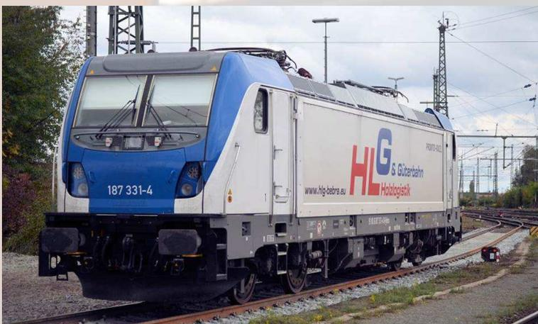
Diese 187er von Holzlogistik und Güterbahn (HGL- Bahn) hat sich nicht auf ein Nebengleis ohne Fahrdrabt verirrt. Sie ist mit dem Last- mile- Dieselpaket ausgestattet und kann auch nicht elektrifizierte Abschnitte befahren. Bei Testfahrten in Velim (CZ) brachte es eine BR187 mit 2230 Tonnen am Haken auf 38 km/h über mehr als 40 Minuten.
