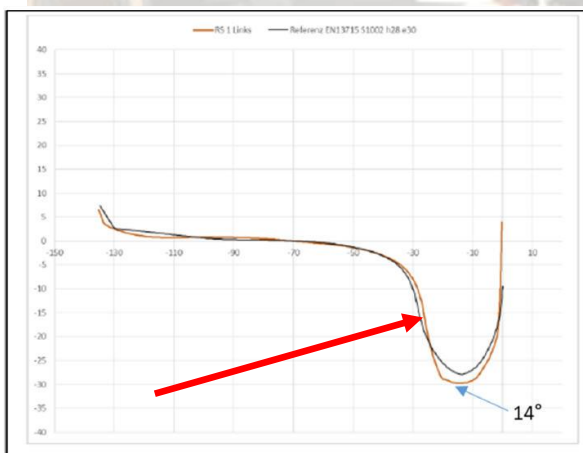
Abbildung 17 im SUST- Bericht: Radlaufflächenprofil des zuerst entgleisten Rades am Wagen 9 im Neu- (blaue Kontur) und nach der Entgleisung verschlissenen Zustand (braune Kontur). Deutlich erkennbar ist der wesentlich steilere Anstieg der Spurkranzflanke im verschlissenen Zustand.
