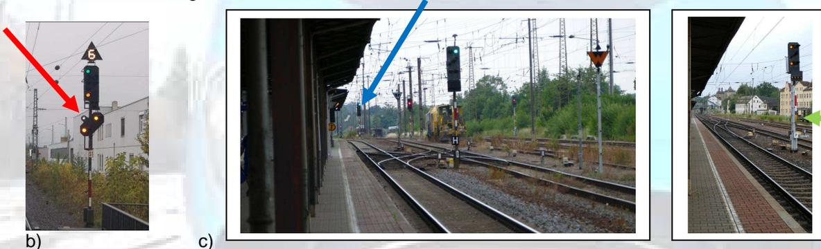
Signalankündigung nach System H/V (b) oder OSShD- Signalsystem (c), wobei hier das angekündigte Hauptsignal links hinten (blauer Pfeil) befindet. Roter Pfeil: Kennlicht, der den Vorsignalschirm zwar als eigenständiges Vorsignal ausweist, allerdings mit einem Bremsweg < 950 m, grüner Pfeil: Kennschild für ein Hauptsignal mit Vorsignalfunktion.
