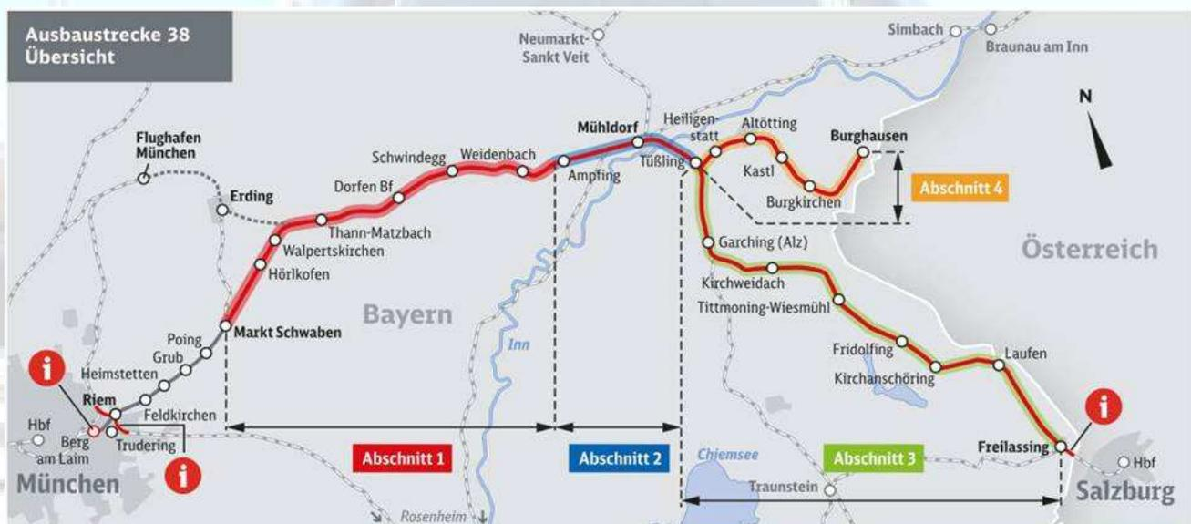
Der gesamte Ausbau der Alternativstrecke ist in drei Abschnitte – wie dargestellt – aufgeteilt, eigentlich in vier, wenn man die beiden Verbindungskurven Daglfing und Trudering einrechnet (Quelle: DB AG [www.abs38.de](http://www.abs38.de)).
