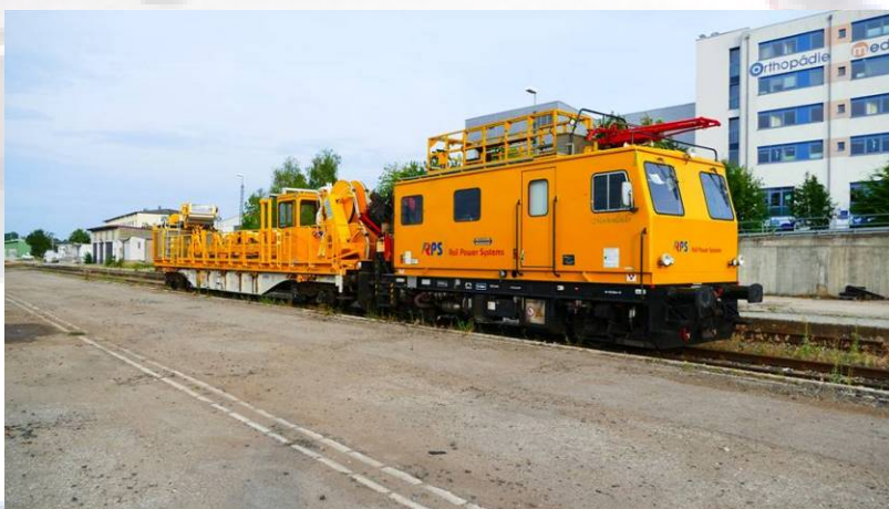
Mitte Juli machte im Zuge verschiedener Bauarbeiten rund um Ansbach auch dieser Oberleitungs- Revisionstriebwagen mit Kabelwagen Station in Ansbach.
