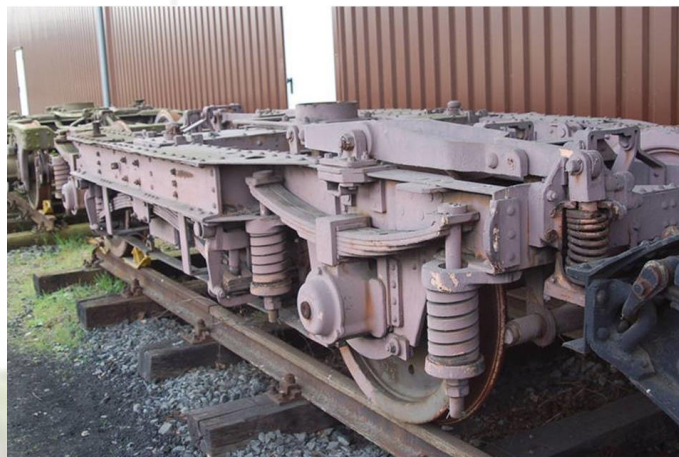
Ein zunächst normales Drehgestell der Bauart Görlitz III leicht, mit einer kleinen Besonderheit, die rechts im Vordergrund zu sehen ist: Es dürfte sich hierbei um die erste Bauform eines rein mechanisch wirkenden Gleitschutzes handeln. Die Funktion ist ungefähr so: Kommt es bei Voll- oder Schnellbremsungen im unteren Geschwindigkeitsbereich zu einem „Festpappen“ der Bremsklotzsohlen am Rad, wird über den Hebel (grüner Pfeil) das Entlüftungsventil (roter Pfeil) geöffnet. Das reduziert den Druck im Bremszylinder, und zwar genau so lange, bis die Bremsklotzsohlen vom Rad ablegen und die Ursache für diesen rein mechanischen Vorgang aufgehoben ist. Die ganze Konstruktion hat nur einen Haken: Eine Blockierung des Radsatzes verhindert sie nicht. Fotografiert von Reinhold Fröhlich im Eisenbahnmuseum Bochum- Dahlhausen.
