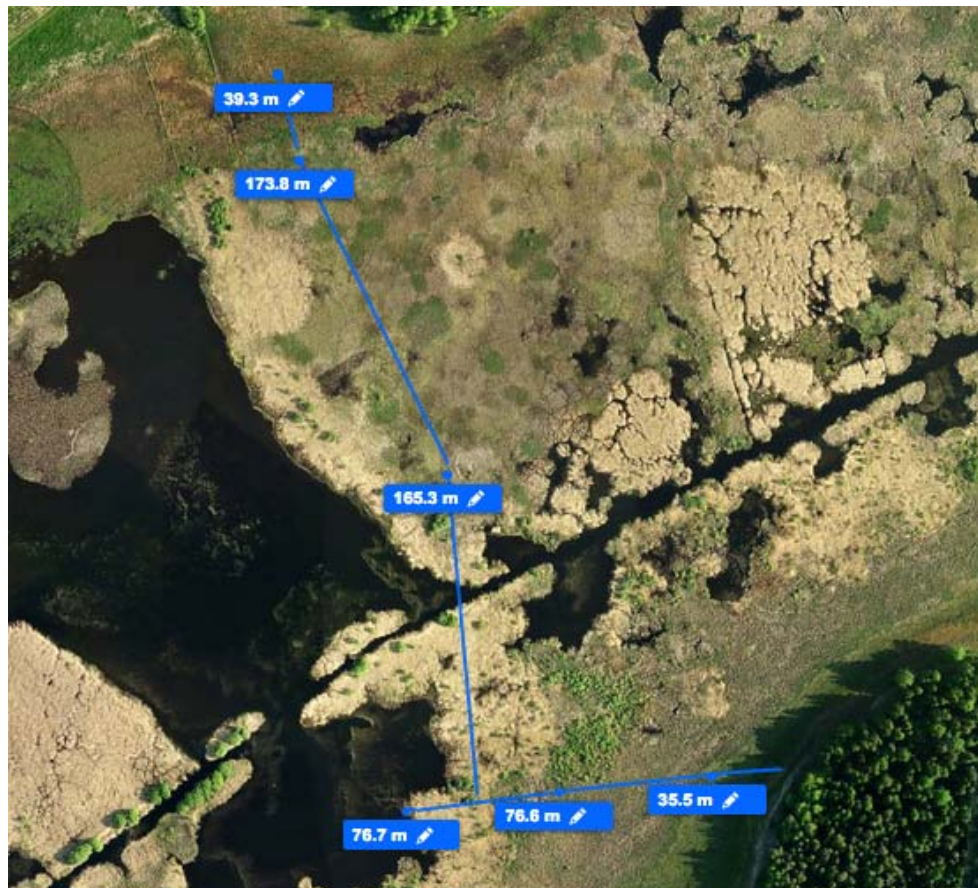
Figur 18. Beräknade längder på eventuell spång över olika typer av vegetation, vilket kommer ställa olika krav på grundläggning och därmed medföra olika kostnader.
