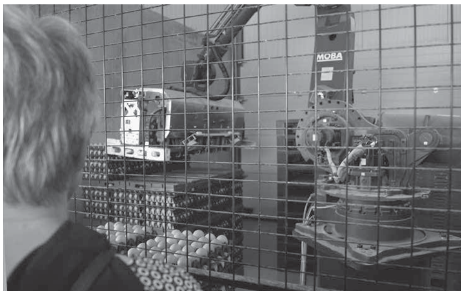
De computer is niet weg te denken in het bedrijf. De eieren worden automatisch in de verpakking geplaatst en door een robot op paletten geplaatst.
