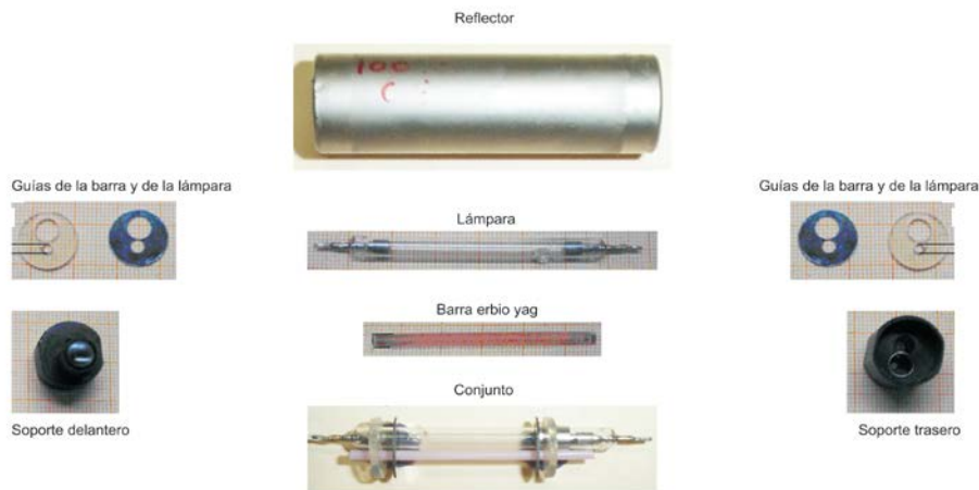
Fig. 3.5. Componentes de la cavidad láser. González Hernández, M. "Lanceta Láser". ISDi, 2007.
