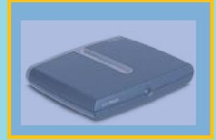
Quant au **"router"**, cet appareil, branché sur le modem, permet non seulement de partager le signal pour plusieurs PC mais aussi de connecter la télévision ou le téléphone. Exemples : Belgacom TV et ITalk.
