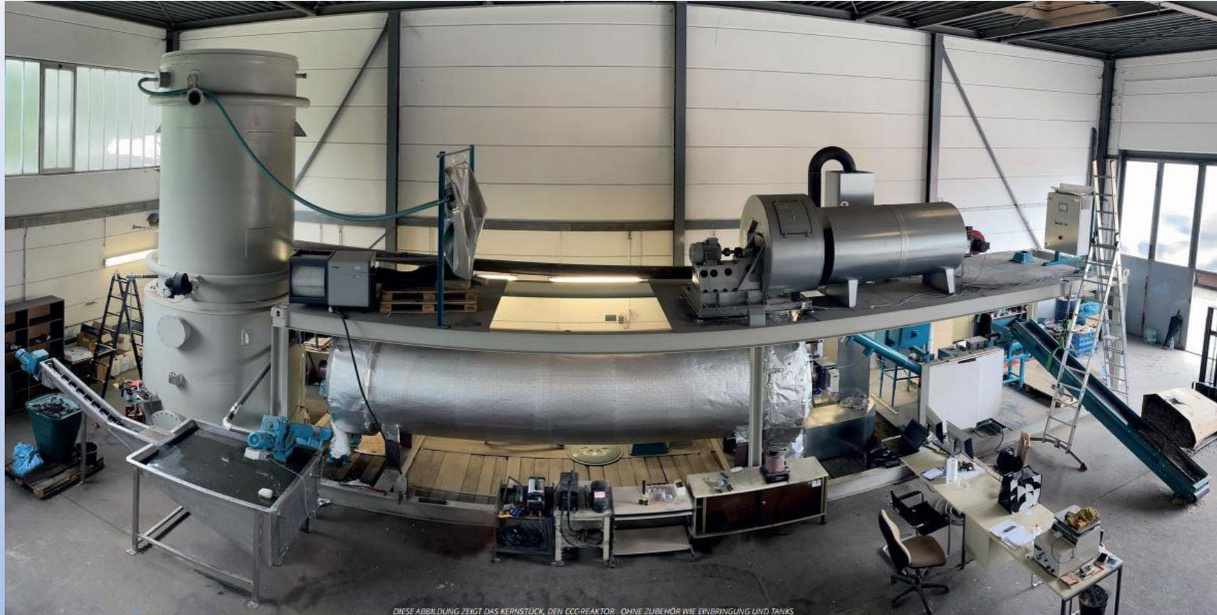
DIESE ABBILDUNG ZEIGT DAS KERNSTÜCK, DEN CCC-REAKTOR. OHNE ZUBEHÖR WIE EINBRINGUNG UND TANKS
