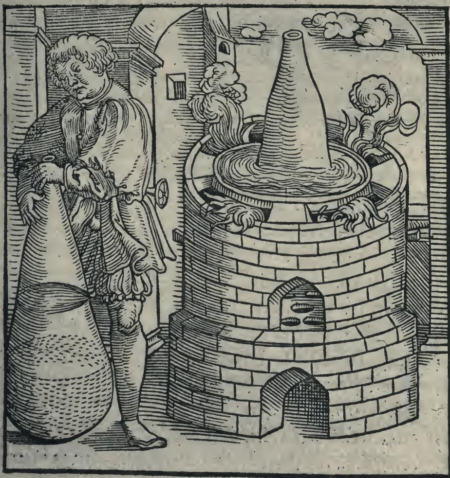
Lösen von Substanzen im Wasserbad.
