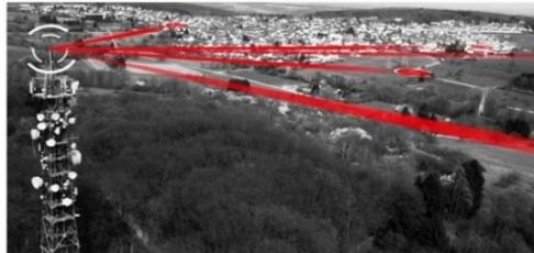
Beamforming mit 5G Antenne (Makrozelle) – Vodafone Deutschland
