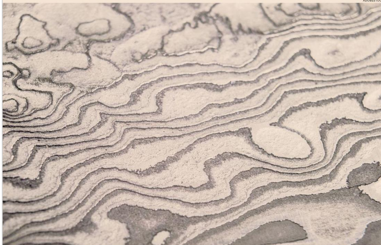
Effetto seta. Un'immagine ravvicinata dell'acciaio damascato
