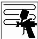
2-3 Schichten auftragen (bis zum Erreichen der Deckkraft). Zwischen den Schichten vollständig ablüften.
