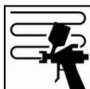
Basislack Farbton M29V Ice Black gemäß technischem Datenblatt auf die zu reparierende Fläche auftragen und vollständig trocknen lassen.
