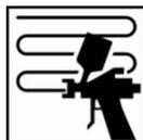
Basislack Farbton (P)EJD Ice Grey gemäß technischem Datenblatt auf die zu reparierende Fläche auftragen und vollständig trocknen lassen.
