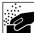
P320 Schleifen mittels Klotz um die letzten Unebenheiten der Reparaturfläche zu entfernen.
