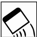
Geeigneten Polyesterspachtel auftragen. Falls möglich sollte vorher Primer Surfacer EP II aufgetragen werden.
