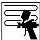
Eine dünne Schicht auftragen, schrittweise den transparenten Grundfarbton außerhalb der Reparaturstelle ausweiten, um einen glatten und transparenteren Übergang der Reparaturstelle zum OEM Farbton zu erreichen.
