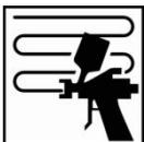
Auftragen einer dünnen Schicht, schrittweises einlackieren dieser Schicht, um einen gleichmäßigeren Auslauf des Grundfarbtons sowie einen glatteren Übergang zum originalen OEM Farbton zu erreichen.
