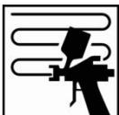
Auftragen einer dünnen Schicht, schrittweises einlackieren dieser Schicht, um einen gleichmäßigeren Auslauf des Grundfarbtons sowie einen glatteren Übergang zum originalen OEM Farbton zu erreichen.
