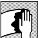
Entfernen Sie vor dem Decklack-/ Klarlackauftrag jegliche Oberflächenverunreinigungen unter Verwendung entsprechender Oberflächenreiniger.
