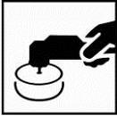
Zuerst die Beilackierzone von Hand mit einem feinen Polierpräparat polieren. Falls dies einen großen Arbeitsaufwand erfordert, kann maschinell, mit einem gröberen Polierpräparat, poliert werden.
