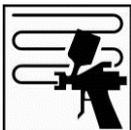
1-3 dünne Schichten in den beilackierten Bereich auftragen, Fläche bis zum polierten Bereich ausdehnen.
