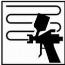
Eine volle verlaufende Schicht über die Beilackierzone auftragen. Die Randzonen der lackierten Schicht sollten leicht in den polierten Bereich fallen.
