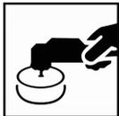
Beilackierzone gründlich mit einem abrasiven Polierpräparat polieren, vorzugsweise in Verbindung mit einer Poliermaschine.
