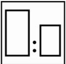
Zugabe von 0-10 Teilen Activator WB als Standardmischungsverhältnis für alle Autowave Unifarbtöne. Zugabe von 10-20 Teilen Activator WB als Standardmischungsverhältnis für alle Autowave Metallic- und Effektfarbtöne.
