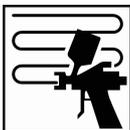
Einen mittleren geschlossenen Spritzgang auftragen. Eine Zwischenablüßzeit von 6-10 Minuten bei 20°C gewähren.
