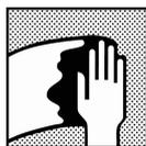
Oberflächenreinigung; Entfernen Sie vor dem Auftragen des Decklackes jegliche Oberflächenverunreinigung unter Verwendung entsprechender Oberflächenreiniger.
