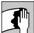
Oberflächenreinigung; Entfernen Sie vor dem Auftragen von Autosurfacer Rapid jegliche Oberflächenverunreinigung unter Verwendung entsprechender Oberflächenreiniger. *Wo Spachtel zugegen ist, Kontakt mit Wasser vermeiden (z.B. wasserbasierende Reiniger).*
