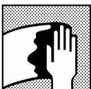
Oberfläche gründlich trocknen und vor dem Auftragen des Decklackes jegliche Oberflächenverunreinigung unter Verwendung entsprechender Oberflächenreiniger entfernen.
