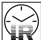
Vor Infrarot-Trocknung eine Ablüftzeit von 5 Minuten gewähren.
