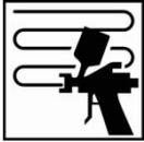
Einen mittleren geschlossenen Spritzgang auftragen, gefolgt von einer Ablüftzeit von 5-10 Minuten bei 20°C. Anschließend eine volle Schicht auftragen und vor der Ofentrocknung eine Ablüftzeit von 5-10 Minuten bei 20°C gewähren.
