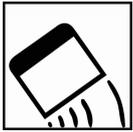
Zum Auftragen des Spachtels auf den blanken Untergrund, Spachtelmesser in einem Winkel von 60° halten. Vermeiden Sie dicke Spachtelränder im Umkreis der Reparaturstelle, indem Sie den Spachtel auslaufend zum Originallack ziehen.
