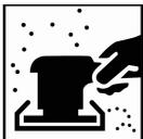
Entfernen bestehender Lackschichten und als letzten Schleifschritt mit P180 - P220 trocken bis auf den blanken Untergrund schleifen.
