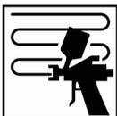
Eine Schicht über die gesamte geschliffene Fläche auftragen. Anschließend eine zweite und dritte Schicht innerhalb der vorangegangenen Schicht auftragen. Bei der Lackierung von ganzen Teilen 2-3 Schichten über das gesamte Teil auftragen, abhängig von der benötigten Schichtdicke.
