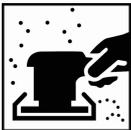
Entfernen bestehender Lackschichten und als letzten Schleifschritt mit P180 - 220 trocken bis auf den blanken Untergrund schleifen.
