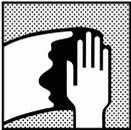
Entfernen Sie vor dem Schleifen jegliche Oberflächenverunreinigungen unter Verwendung entsprechender Oberflächenreiniger.
