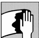
Entfernen Sie vor dem Auftragen von Grundierung/Füller jegliche Oberflächenverunreinigung unter Verwendung entsprechender Oberflächenreiniger.
