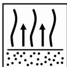
Zwischen den Schichten eine Abluftzeit von 4-8 Minuten bei 20°C gewähren.
