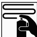
Sprühdose ca. 12-18 cm entfernt vom Teil halten und 1-2 gleichmäßige Schichten auftragen.
