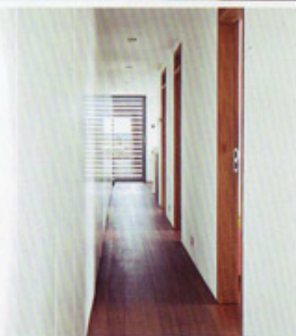
Ci-dessus : les armoires de rangement de chaque chambre se trouvent dans le couloir de nuit, au nord de l'habitation, où elles forment une sorte de tampon thermique.
